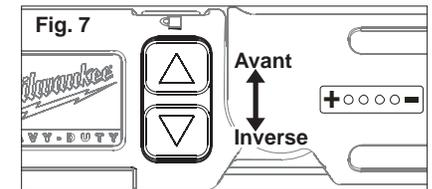
Appuyer et maintenir l'inverseur de sens de rotation vers le haut pour une rotation avant et vers le bas pour une rotation arrière. L'inverseur revient automatiquement à la position centrale d'arrêt marquée « OFF » lorsqu'il est relâché.
