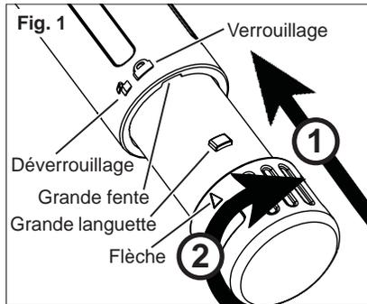
Aligner les grandes et petites languettes placées sur la batterie avec les grandes et petites fentes dans l'ouverture de l'outil. Insérer complètement la batterie dans l'outil. Tourner la batterie dans le sens horaire afin de la verrouiller dans le chargeur. La flèche sur la batterie s'alignera avec l'outil.
