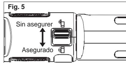
Una vez que se ha instalado la batería, la herramienta está en condiciones de operación. El interruptor de seguridad previene encendidos accidentales ya que bloquea al interruptor de acción y reversa. Siempre coloque el interruptor de seguridad en posición de "asegurado" ("lock") antes de realizar operaciones como: darle mantenimiento, cambiar accesorios, almacenar la herramienta o en cualquier otra ocasión en que no se vaya a usar la herramienta.
