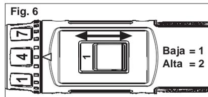
1. Para la velocidad baja (200 RPM) y mayor torque, empuje hacia atrás el selector de velocidad (se muestra "1").
