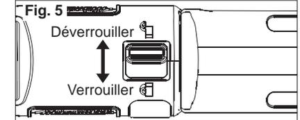
Lorsque la batterie est dans l'outil, celui-ci est prêt à fonctionner. Le verrou de rotation prévient les démarrages accidentels en bloquant l'inverseur de rotation. Placez toujours le verrou de rotation à la position marquée « LOCK » avant de faire l'entretien de l'outil, d'en changer les accessoires ou de le ranger lorsqu'il ne sert pas.
