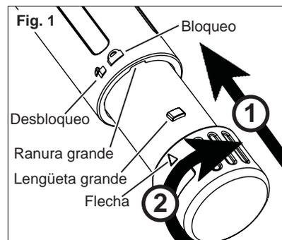
Alinee las lengüetas grande y pequeña de la batería con las ranuras grande y pequeña en la abertura de la herramienta. Deslice completamente la batería en la herramienta. Gire la batería en sentido horario para fijarla en su lugar. La flecha de la batería se alineará con el en la herramienta .
