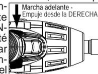
motor se pare por completo. Para **avanzar** (el giro es en el sentido de las manecillas del reloj), se presiona el interruptor de control colocado al lado derecho del taladro. **Verificar la dirección del giro antes de usarlo.**
